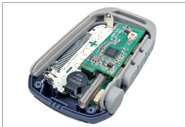
Пример встроенной в брелок антенны
