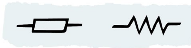
Обозначение резисторов на электрических схемах
