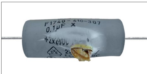
Взорвавшийся конденсатор
