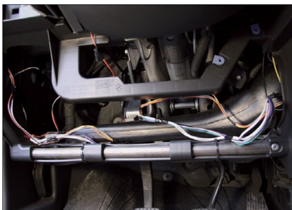
Незакрепленные провода
