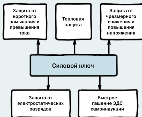
Структурная схема силового ключа
