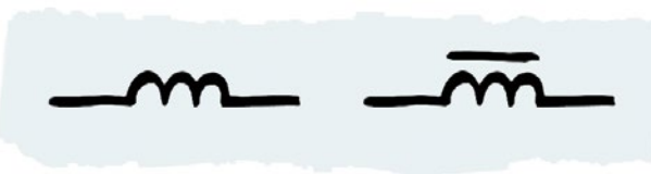
Условное обозначение катушки индуктивности без сердечника и с сердечником
