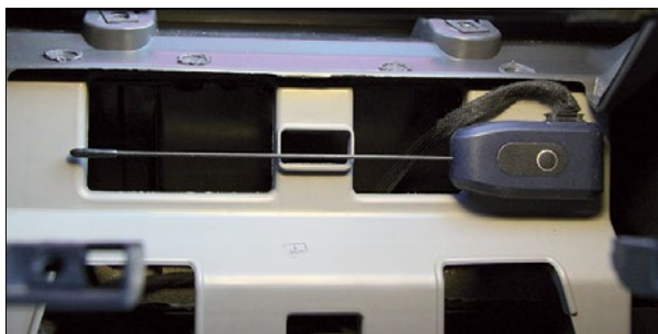
Модуль приемопередатчика под накладкой торпеды
