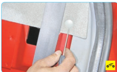
3. Подденьте отверткой пистон крепления обивки задней полки...
