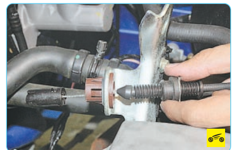
26. ...извлеките трос из отверстия кронштейна и отведите в сторону.
