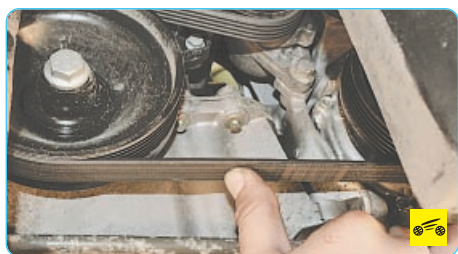
3. Проверьте натяжение ремня по правилу «большого пальца»: надавливая на ветвь ремня большим пальцем и определяя прогиб линейкой. Согласно этому универсальному правилу, если расстояние между центрами шкивов составляет 180–280 мм, прогиб должен быть примерно 6 мм.
