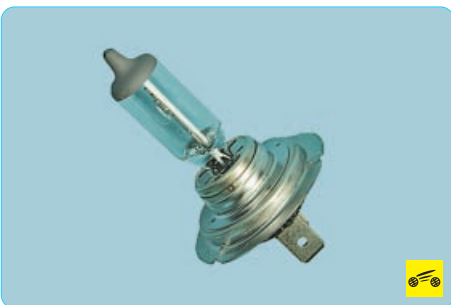
7. Установите новую лампу ближнего света в блок-фару.
