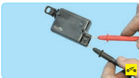
5. При подаче тока шток электропривода должен втянуться. Если этого не произошло, замените электропривод новым.
