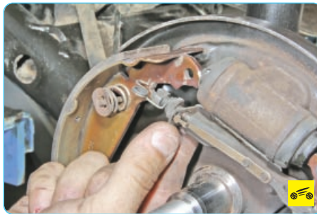
14. Придерживая распорную планку, немного отведите вперед переднюю колодку...
