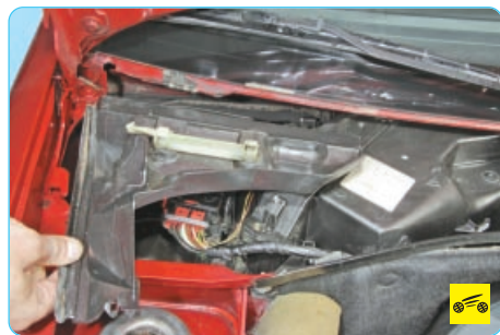
7. Снимите водоотводящий щиток.
