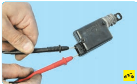
8. Для проверки электропривода замка подайте напряжение 12 В на выводы привода.
