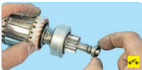
18. Снимите ограничительное кольцо и муфту с вала привода.
