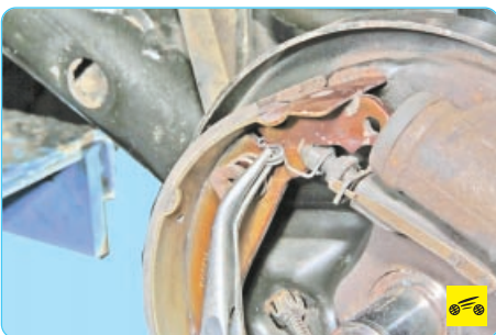
12. Захватив пассатижами ветвь серьги регулятора зазоров...
