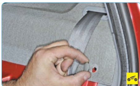
4. ...и извлеките пистон из отверстия. Аналогично извлеките остальные пистоны крепления обивки задней полки.
