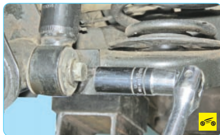
7. Выверните болт крепления амортизатора к рычагу задней подвески...
