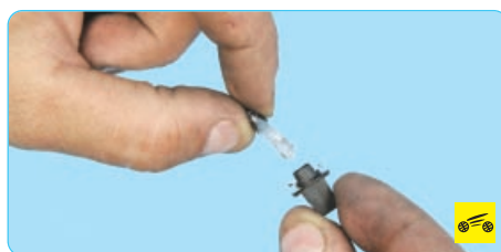
22. Извлеките бесцокольную лампу из патрона. Аналогично замените вторую лампу подсветки блока управления климатической системой.
