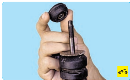
9. Снимите со штока амортизатора нижнюю резиновую подушку...
