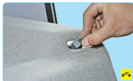
11. ...проденьте в проем обивки задней полки также пряжку ремня и нижнего крепления ремня безопасности.
