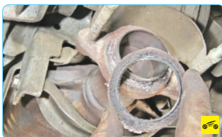
11. Установите детали в порядке, обратном снятию, заменив оба уплотнительных кольца.
