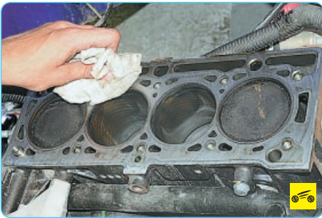
42. Очистите привалочные поверхности головки и блока.
