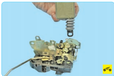
7. Разворачивая привод, как показано на фотографии, снимите его.
