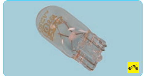
7. Установите новую лампу габаритного огня в блок-фару.
