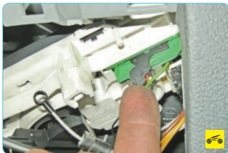
14. ...и, сдвинув фиксирующую скобу...
