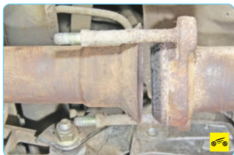
5. ...и отведите в сторону фланец нейтрализатора.
