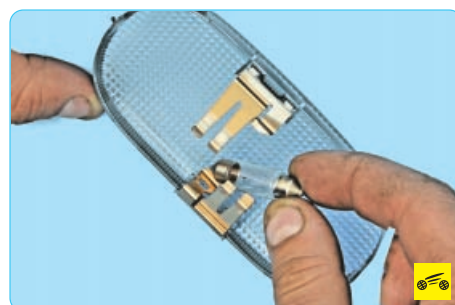
4. Извлеките лампу из держателей в рассеивателе.
