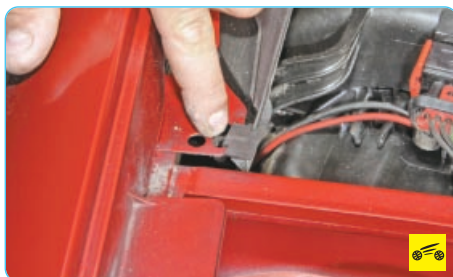
4. Отожмите фиксатор водоотводящего щитка, сдвиньте щиток в направлении стрелки...
