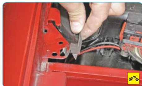
6. ...и выведите фиксатор из отверстия в кронштейне моторного отсека.
