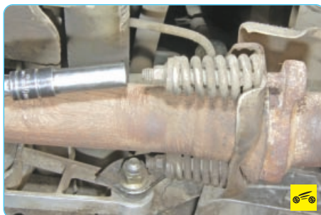
2. Отверните две гайки крепления нейтрализатора к блоку основного и дополнительного глушителей...
