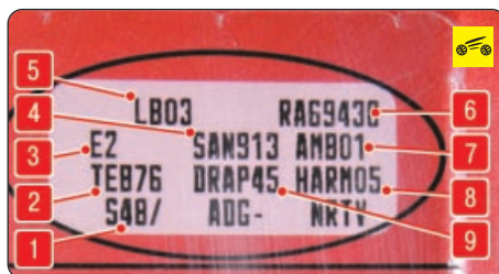
Рис. 1.6. Идентификационная наклейка исполнения автомобиля: 1 – техническая характеристика автомобиля; 2 – код цвета кузова; 3 – уровень комплектации; 4, 7 – коды специальной комплектации; 5 – тип автомобиля; 6 – заводской номер; 8 – код цветовой гаммы интерьера; 9 – код обивки салона
