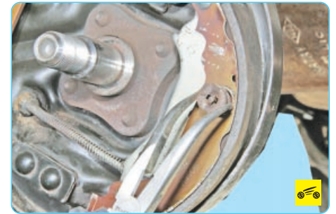
19. Придерживая опорную стойку, нажмите на чашку крепления прижимной пружины, поверните ее на четверть оборота...
