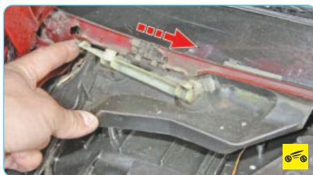
4. Отожмите фиксатор водоотводящего щитка, сдвиньте щиток в направлении стрелки...
