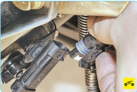
13. Разъедините колодку жгута проводов датчика концентрации кислорода...
