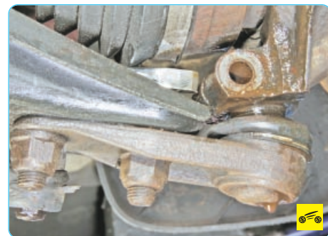
5. Разожмите клеммовое соединение отверткой...
