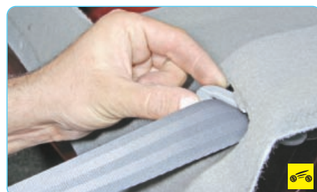
10. Разверните облицовку проема ремня безопасности и проденьте ее в проем обивки задней полки...
