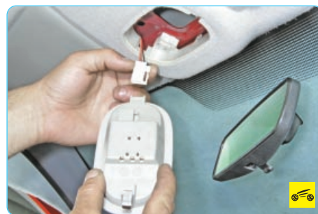
1. Снимите плафон освещения салона (см. «Замена плафона освещения салона», с. 228).
