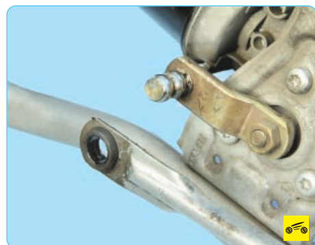
4. ...и снимите тягу трапеции с кривошипа моторедуктора.
