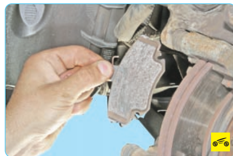
6. ...и внутреннюю тормозные колодки.
