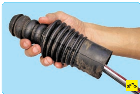
9. ...и буфер сжатия с защитным чехлом.
