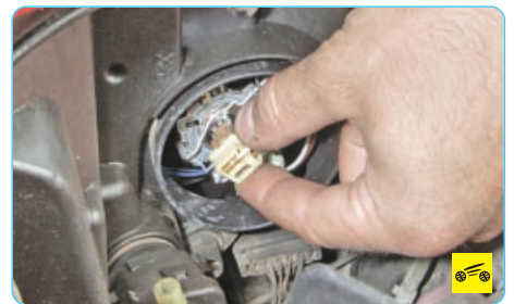
3. Сожмите фиксатор колодки жгута проводов лампы дальнего света...
