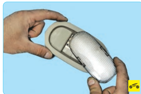
3. ...и снимите рассеиватель с корпуса плафона.
