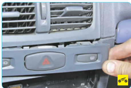
2. ...и отведите блок выключателей от панели приборов.
