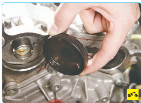
4. ...подденьте и снимите заглушки распределительных валов из задней части головки блока цилиндров.
