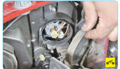
2. Возьмитесь за край крышки лампы и снимите ее.
