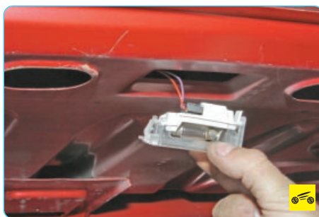
2. ...и извлеките его из проема задней полки.
