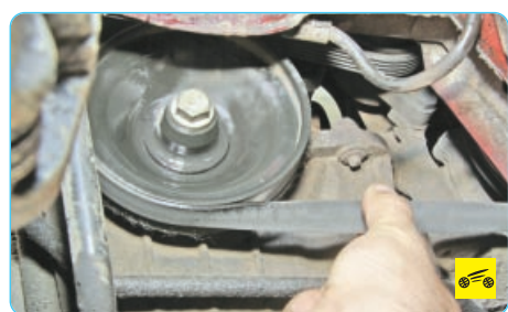
3. Поверните ключом по часовой стрелке ролик натяжного устройства и зафиксируйте натяжное устройство в этом положении штифтом диаметром 6 мм (например, ключом-шестигранником).
