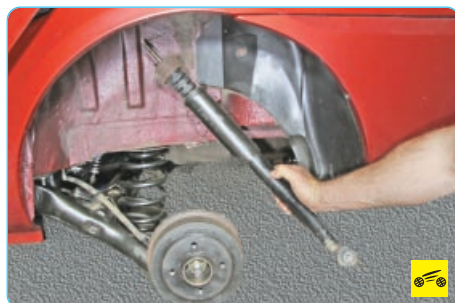
8. ...и снимите амортизатор с автомобиля.
