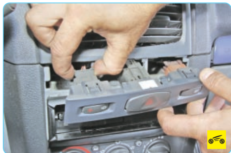
3. Сожмите фиксаторы трех колодок жгутов проводов...
