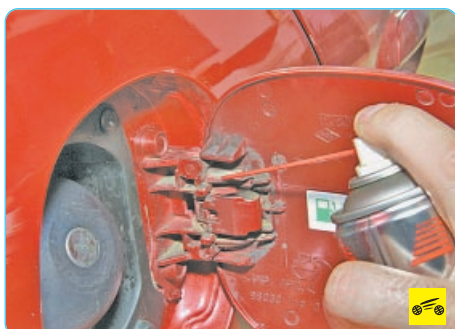
14. ...и крышки люка наливной трубы топливного бака.
