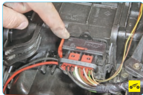
8. Подденьте фиксатор колодки жгута проводов вентилятора отопителя...
