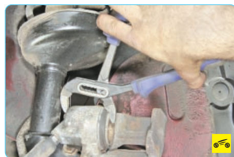
7. Раздвижными пассатижами утопите поршень до упора в дно рабочего цилиндра.
