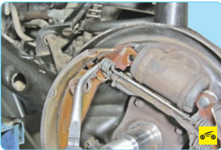
9. Захватив пассатижами ветвь верхней стяжной пружины...
