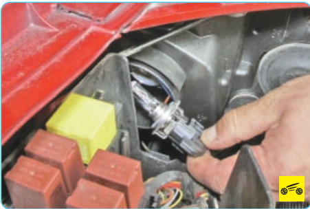
5. ...и извлеките его вместе с лампой из корпуса блок-фары, преодолевая сопротивление пружинных фиксаторов.
