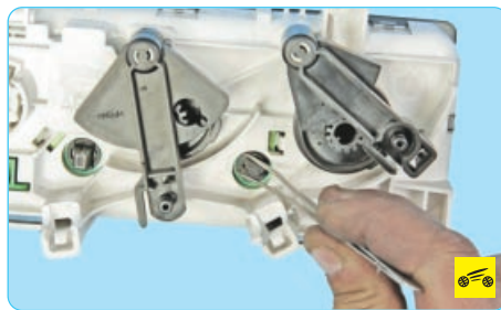
20. ...поверните его против часовой стрелки на 45°...
