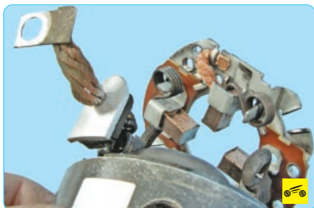
19. Осмотрите щеткодержатель. Проверьте высоту щеток в щеткодержателе. Если высота 7 мм и менее, замените щеткодержатель новым.
