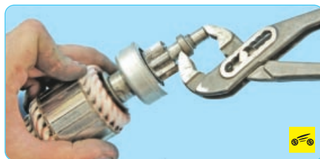
21. Якорь не должен иметь повреждений (забоин и задигов) шлицев и цапф вала. На коллекторе якоря не должно быть следов обгорания. Незначительное обгорание устранили ветошью, смоченной в бензине, и мелкозернистой наждачной бумагой. Изоляционная слюда между ламелями должна быть углублена не менее чем на 0,2 мм. При значительной шероховатости коллектора или выступании слюды между его ламелями проточите коллектор на токарном станке и затем шлифуйте мелкозернистой наждачной бумагой. Минимально допустимый диаметр коллектора 29,4 мм. После проточки углубите на 0,5 мм слюду между ламелями, например, ножовочным полотном. Проверьте надежность припайки выводов обмотки А якоря к ла-
