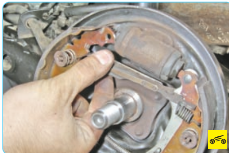
15. ...и отсоедините распорную планку от колодки.
