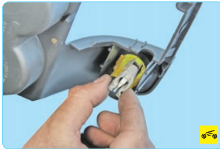
7. Отожмите фиксатор световода патрона прикуривателя...
