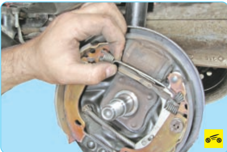
10. ...отцепите ее отогнутый конец от передней колодки...
