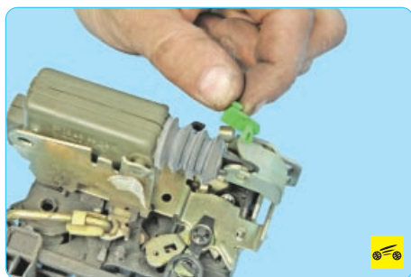
6. ...и снимите фиксатор.
