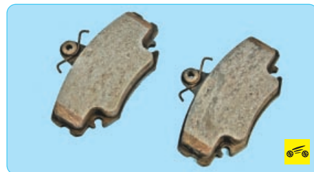
6. ...и внутреннюю тормозные колодки.
