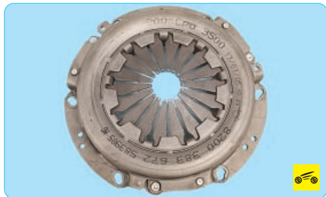
Рис. 6.1. Сцепление и привод его выключения: 1 – ведомый диск; 2 – кожух сцепления с нажимным диском; 3 – подшипник выключения сцепления; 4 – трос привода выключения сцепления; 5 – педаль сцепления; 6 – вилка выключения сцепления
