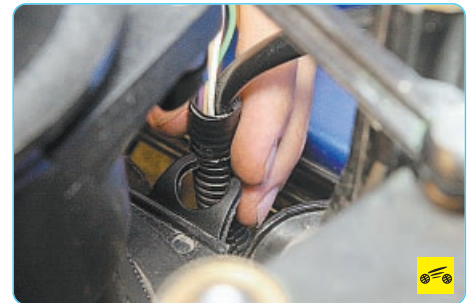
23. Извлеките жгут из среднего верхнего держателя на впускной трубе...
