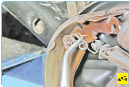
13. ...отцепите ее отогнутый конец от передней колодки.
