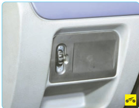
3 – регулятор электрокорректора света фар.
