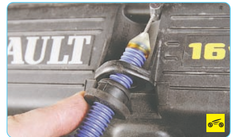
11. ...извлеките трос из кронштейна ресивера и отведите в сторону.
