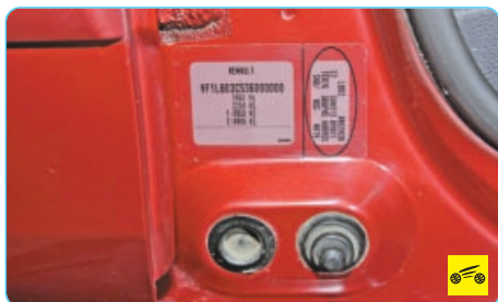
Рис. 1.6. Идентификационная наклейка исполнения автомобиля: 1 – техническая характеристика автомобиля; 2 – код цвета кузова; 3 – уровень комплектации; 4, 7 – коды специальной комплектации; 5 – тип автомобиля; 6 – заводской номер; 8 – код цветовой гаммы интерьера; 9 – код обивки салона
