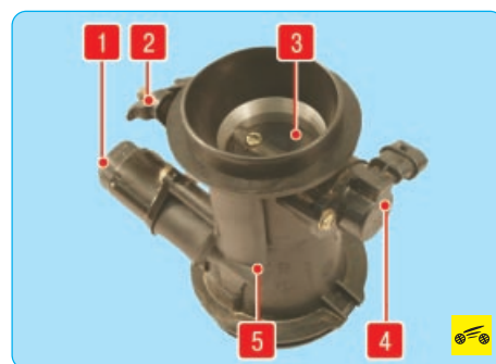
Рис. 5.17. Дроссельный узел: 1 – регулятор холостого хода; 2 – рычаг привода дроссельной заслонки; 3 – дроссельная заслонка; 4 – датчик положения дроссельной заслонки; 5 – корпус дроссельного узла
