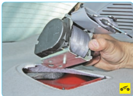
9. ...извлеките катушку ремня безопасности из проема облицовки и снимите ремень.
