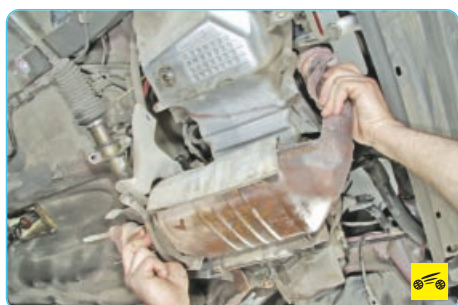
7. ...и снимите каталитический нейтрализатор.
