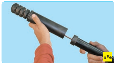
11. ...и буфер сжатия в сборе с защитным чехлом.
