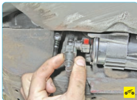
Рис. 5.18. Регулятор холостого хода: 1 – клапан; 2 – корпус регулятора; 3 – обмотка статора; 4 – ходовой винт; 5 – штекерный вывод обмотки статора; 6 – шариковый подшипник; 7 – корпус обмотки статора; 8 – ротор; 9 – пружина
