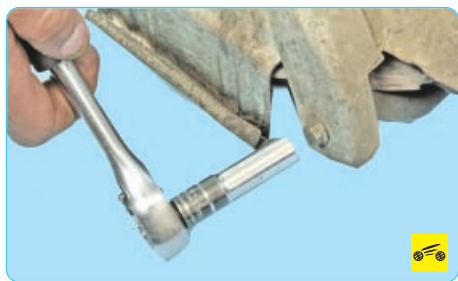
8. Выверните два болта крепления кронштейна к нейтрализатору.
