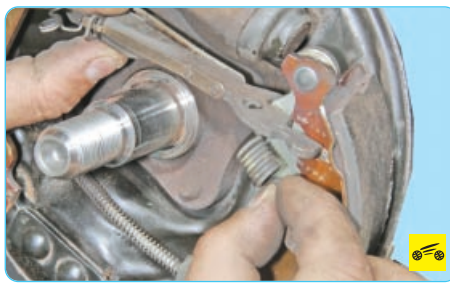
16. Выведите распорную планку из зацепления с задней колодкой и разжимным рычагом, чтобы ослабить натяжение пружины распорной планки...
