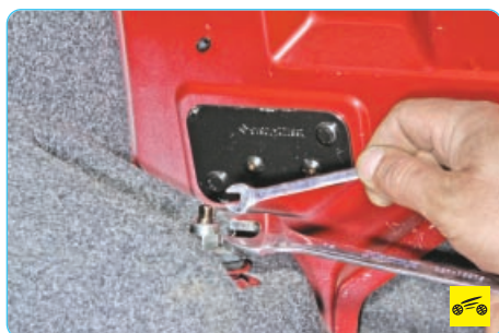
5. Отверните гайку крепления штока амортизатора, удерживая шток от проворачивания вторым ключом.
