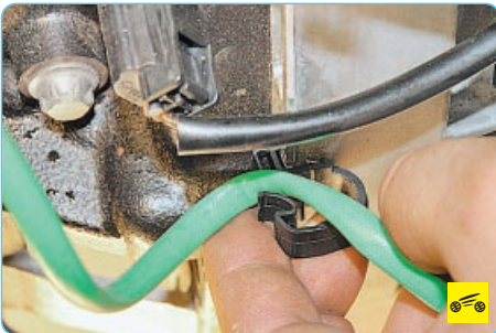
14. ...и выведите жгут из держателя на двигателе.
