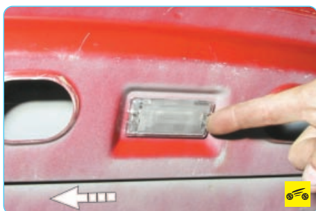
1. Сдвиньте в направлении, показанном стрелкой, плафон освещения багажника...
