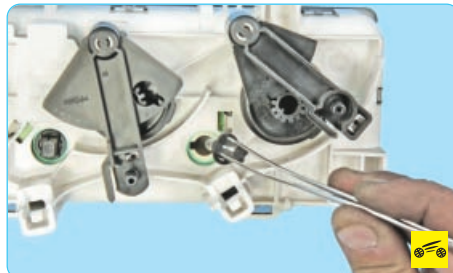
21. ...и извлеките патрон с лампой из блока управления климатической системой.
