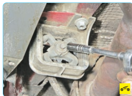
2. Выверните болт крепления кронштейна основного глушителя к подушке.
