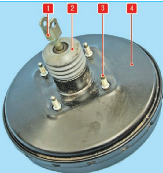
Рис. 9.3. Вакуумный усилитель: 1 – толкатель; 2 – защитный чехол с фильтром; 3 – шпилька крепления вакуумного усилителя; 4 – корпус усилителя
