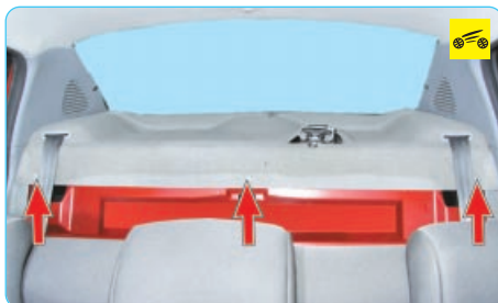
Так расположены пистоны крепления обивки задней полки.
