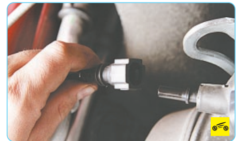
12. Отсоедините от впускной трубы шланг продувки адсорбера.
