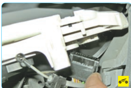
17. ...и, отсоединив колодку от блока управления климатической системой...
