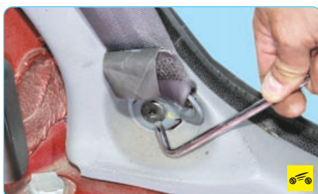
5. Выверните болт нижнего крепления ремня безопасности бокового заднего пассажира...
