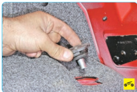
6. Снимите шайбу и верхнюю резиновую подушку с распорной втулкой.
