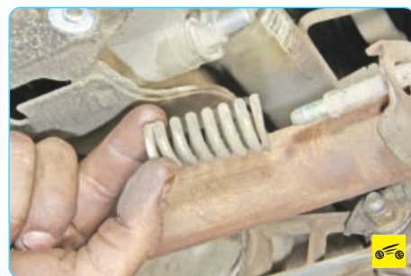
3. ...снимите пружины...
