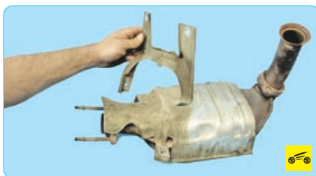
9. Снимите с нейтрализатора кронштейн...
