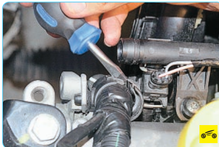
19. Отстегнув отверткой верхние держатели жгута проводов спереди...
