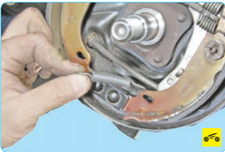
8. ...и снимите пружину.
