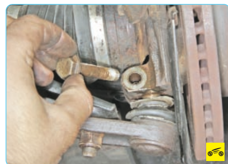
4. ...затем извлеките стяжной болт.
