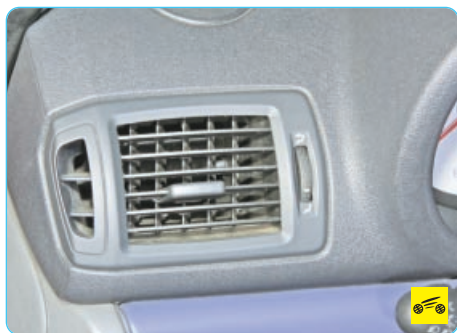
2, 14 – боковые сопла системы вентиляции и отопления салона. Соплами регулируют направление и интенсивность потоков воздуха, см. «Отопление (кондиционирование) и вентиляция салона», с. 19.
