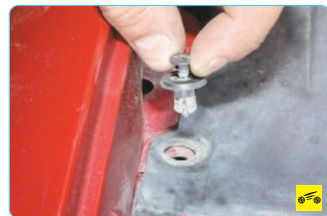
4. ...и извлеките пистон из отверстия.
