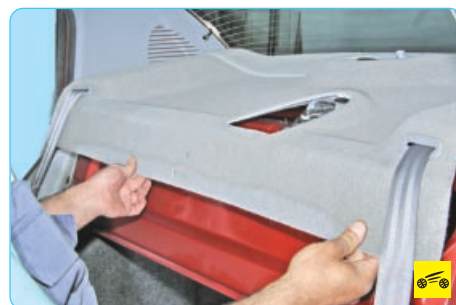
7. Приподнимите обивку задней полки.
