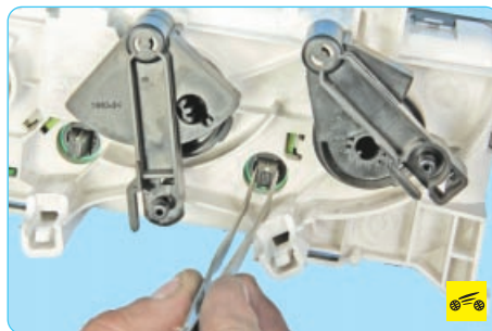
19. Осторожно возьмитесь пинцетом или пассажми за патрон лампы подсветки блока...
