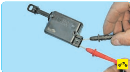
4. Для проверки электропривода замка подайте ток напряжением 12 В на выводы привода.
