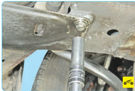
3. Выверните болт переднего крепления щитка.
