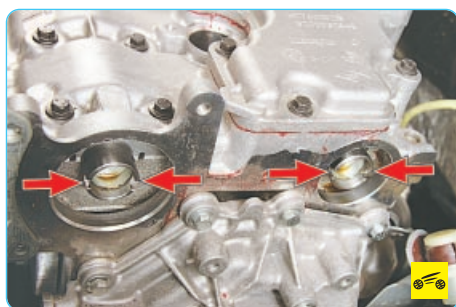
5. При правильной установке поршня 1-го цилиндра в положение ВМТ такта сжатия пазы на концах распределительных валов должны занимать горизонтальное положение и быть смещены вниз относительно оси распределительных валов.
