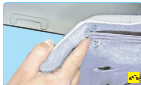
8. Сожмите фиксаторы облицовки проема ремня безопасности...
