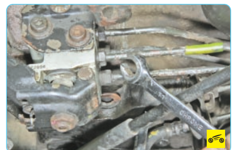
10. Отверните гайку крепления заднего конца трубки к регулятору тормозных сил в гидроприводе задних тормозов...
