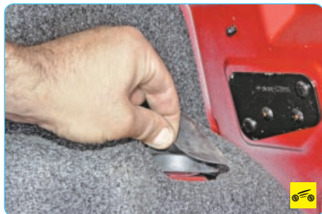
3. Подденьте край защитного чехла верхней опоры амортизатора...
