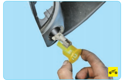
8. ...и снимите световод.
