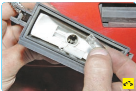
5. Извлеките лампу из фонаря.
