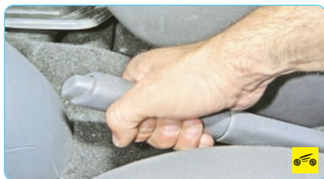
24 – рычаг стояночного тормоза.
