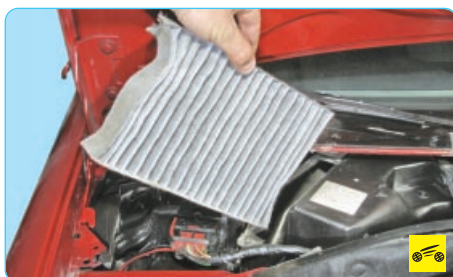
10. ...и извлеките его из отсека корпуса климатического блока.
