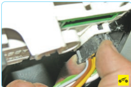
16. Нажмите на фиксатор колодки жгута проводов...
