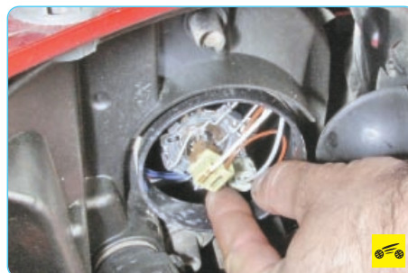
4. Поверните патрон лампы против часовой стрелки...
