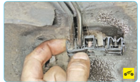
7. Отогните края пяти держателей трубопроводов...
