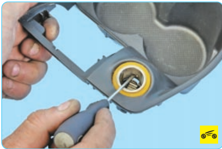
5. Отожмите фиксатор патрона прикуривателя...
