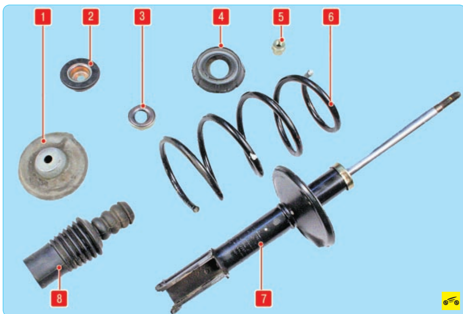
Рис. 7.2. Детали амортизаторной стойки: 1 – верхняя тарелка пружины; 2 – упорная шайба; 3 – опорный подшипник; 4 – верхняя опора стойки; 5 – гайка штока амортизатора; 6 – пружина; 7 – амортизатор; 8 – буфер сжатия с защитным чехлом
