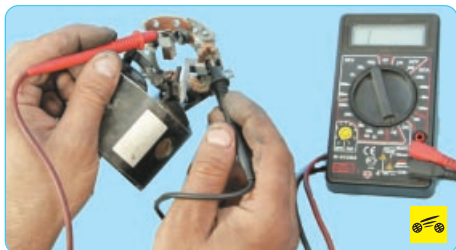
20. Проверьте изолированные держатели щеток на замыкание с корпусом с помощью омметра. Сопротивление должно стремиться к бесконечности.
