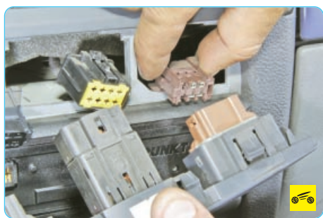
4. ...и отсоедините колодки от выключателей.
