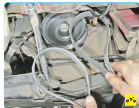
4. Снимите ремень привода вспомогательных агрегатов.
