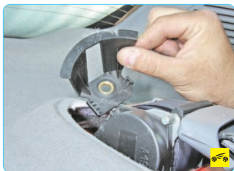
8. Снимите кронштейн облицовки задней полки...
