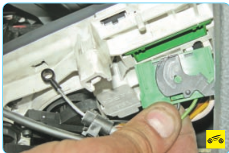
15. ...отсоедините колодку жгута проводов от блока.
