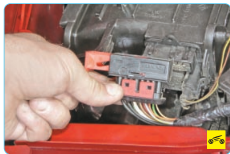
10. ...и отсоедините колодку жгута проводов от вентилятора.
