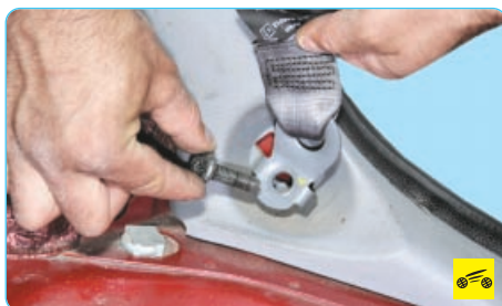
6. ...извлеките болт из отверстия и отсоедините пряжку от кузова.
