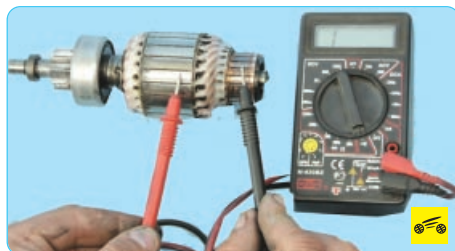
22. Проверьте обмотку якоря на замыкание «на массу» с помощью омметра. Сопротивление должно стремиться к бесконечности.
