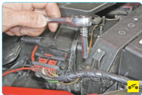
7. Выверните винт крепления крышки фильтра поступающего в салон воздуха, извлеките винт из отверстия...
