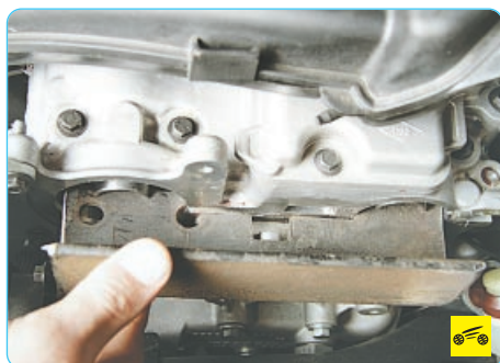
6. Зафиксируйте распределительные валы в этом положении фиксатором распределительных валов.
