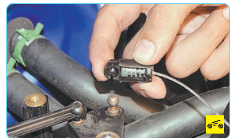
25. Снимите с шарового пальца промежуточного рычага наконечник троса привода дроссельной заслонки...
