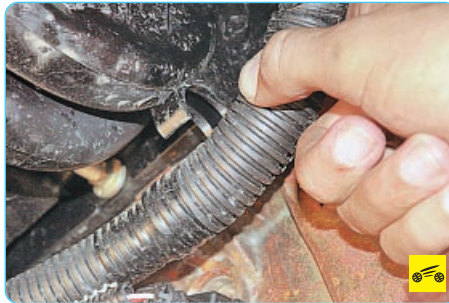
17. Выведите жгут проводов из держателей на впускной трубе сзади...
