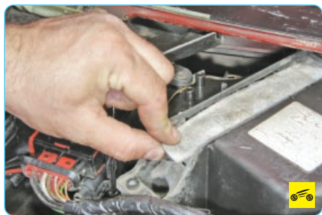
9. Подденьте край фильтра поступающего в салон воздуха...
