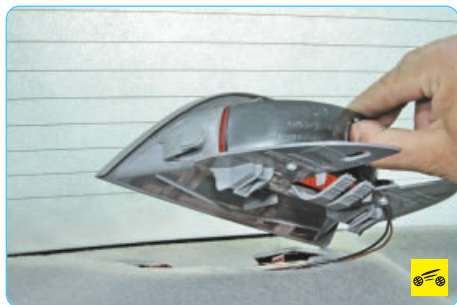
1. Снимите дополнительный стоп-сигнал (см. «Замена дополнительного стоп-сигнала», с. 227).
