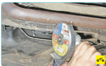
1. Между основным и дополнительным глушителями нанесены специальные метки, посередине между которыми нужно распиливать трубу.
