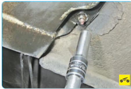
2. ...и бокового креплений защитного щитка трубопроводов.
