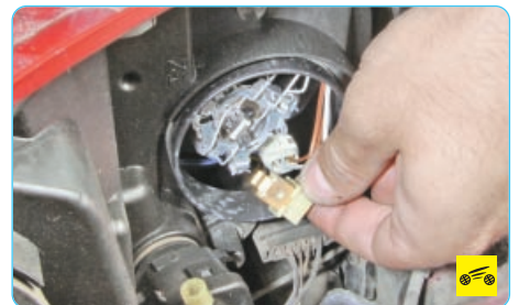
4. ...и отсоедините колодку от цоколя лампы.
