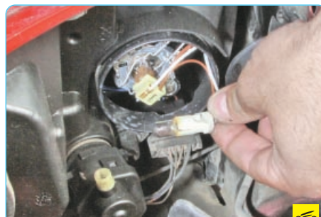
5. ...и извлеките его из блок-фары.
