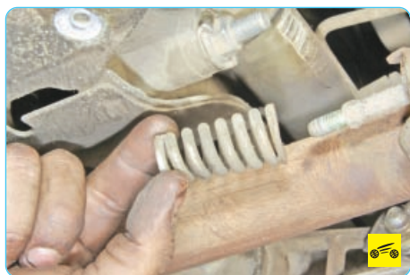
4. Снимите пружины...
