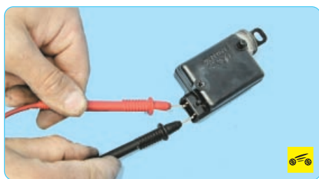
9. При подаче напряжения шток электропривода должен втянуться. Если этого не произошло, замените электропривод новым.
