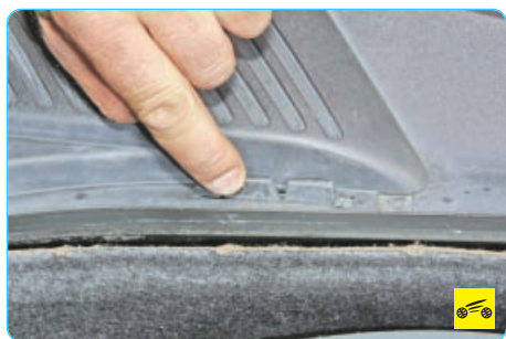
5. Отожмите фиксаторы решетки...
