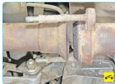
4. ...и отведите в сторону фланец нейтрализатора.
