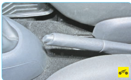
24 – рычаг стояночного тормоза.
