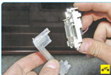
4. ...и разберите плафон освещения багажника.
