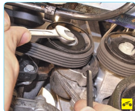
3. Поверните ключом по часовой стрелке ролик натяжного устройства и зафиксируйте натяжное устройство в этом положении штифтом диаметром 6 мм (например, ключом-шестигранником).
