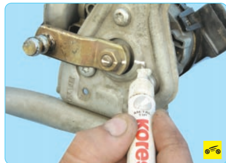
5. Пометьте любым способом взаимное расположение кривошипа, оси моторедуктора и кронштейна трапеции.
