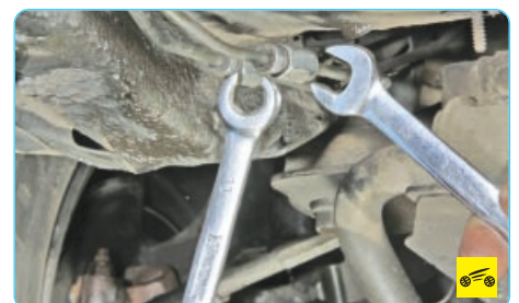
9. Отверните гайку переднего конца трубки из соединительной муфты, удерживая муфту вторым ключом.
