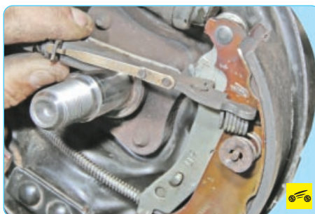
16. Выведите распорную планку из зацепления с задней колодкой и разжимным рычагом, чтобы ослабить натяжение пружины распорной планки...
