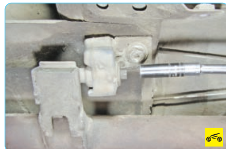
5. Выверните болт крепления кронштейна дополнительного глушителя к подушке.
