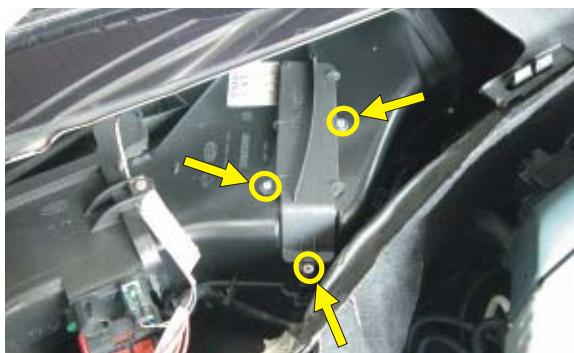
**(PL)** Odkręcić wkręty pokrywy filtra, usunąć pokrywę
